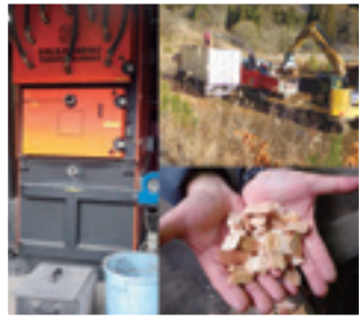
移動式チップパー→木質チップ→チップボイラー
